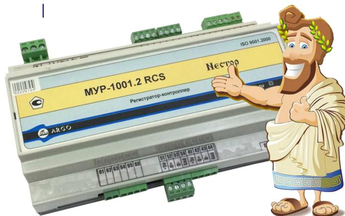
Микропроцессорное устройство регистрации (регистратор) предназначено для использования в системах АСКУЭ, решения задач АСУ ТП и др., в которых предусматривается:
