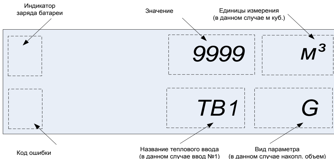
Рис. 2. Расположение полей вывода информации на индикаторе тепловычислителя «МУР 1001.5 SmartOn ТТР ГР (ОД)».
