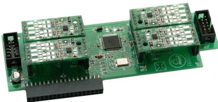
Рис. 2.13. Вариант установки ММ на многофункциональную плату
