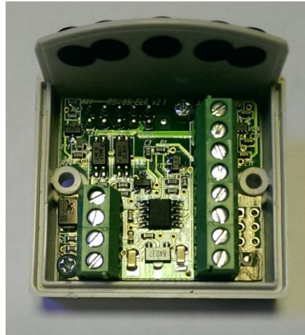
Рис.2. Модуль RS485_ELF во вставном отсеке теплосчётчика
